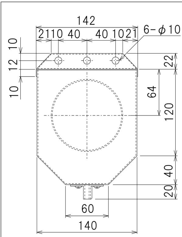
ターボファン用ノズル KSX型 概略寸法図
